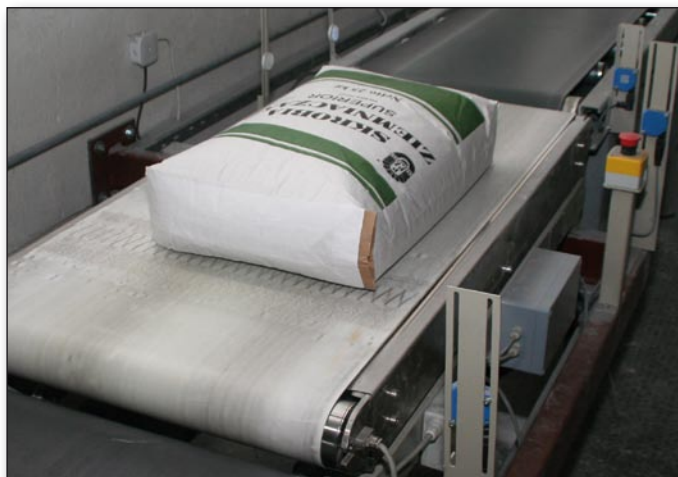
Dynamiczna waga kontrolna EWK-60 zainstalowana w ciągu transportowym
