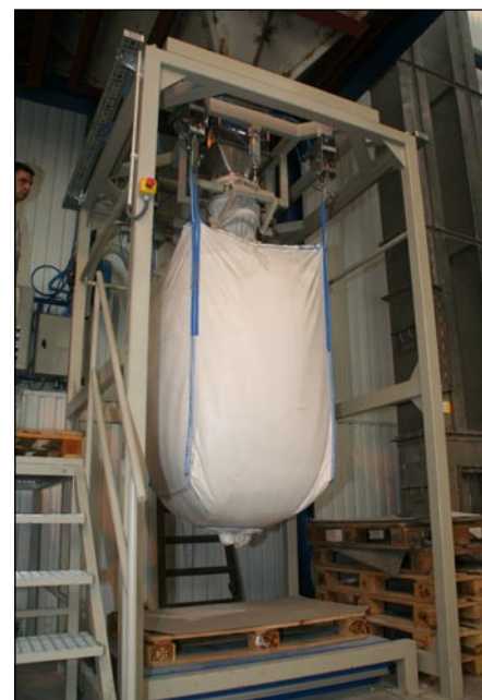
Fot. 1. Urządzenie EWN-BB z wagą u góry
