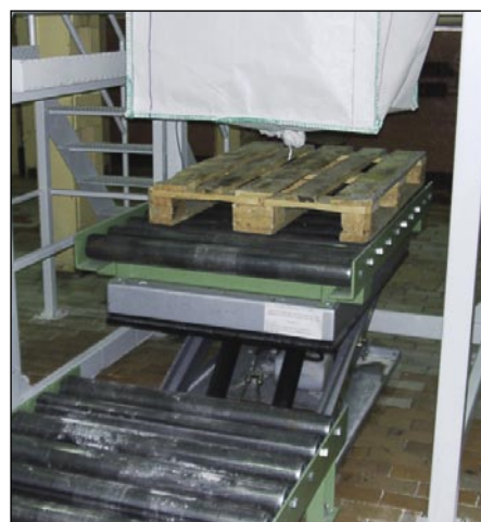
Fot. 8. Układ odbioru worków ze stołem nożycowym
