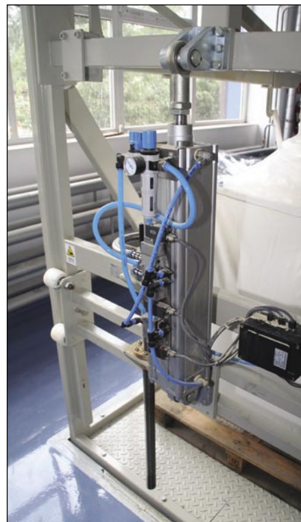
Fot. 7. Układ automatycznego opuszczania worka
