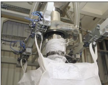
Fot. 3. Worek w trakcie napełniania (w układzie podnoszonych zawiesi)
