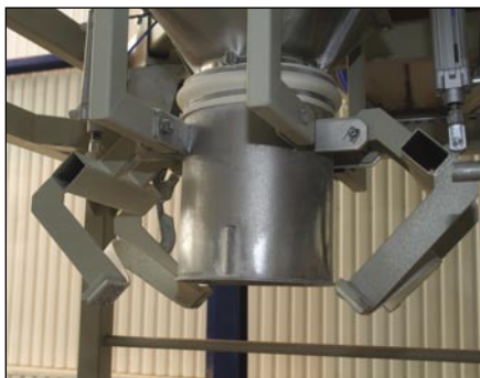
Fot. 5. Układ automatycznego zaciskania rękawa
