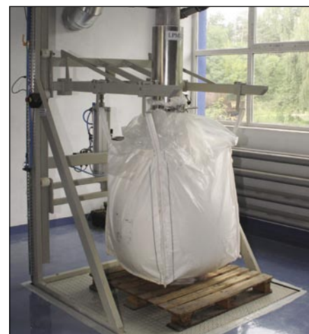
Fot. 2. Urządzenie EWN-BB z wagą w platformie dolnej
