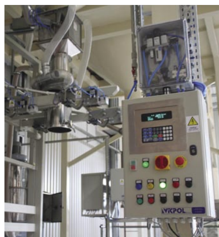
Fot. 9. Układ sterowania z procesorem GSE
