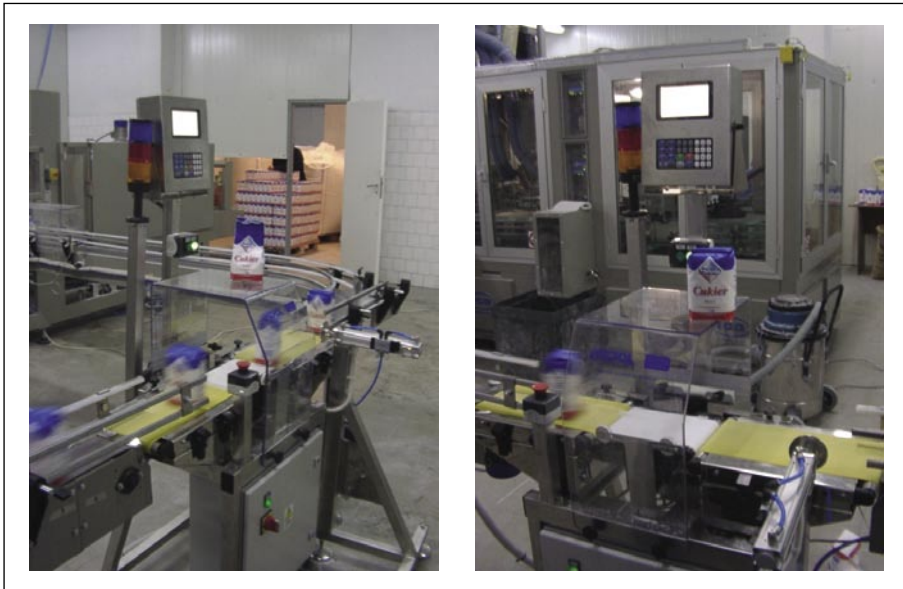
Rys. 3. Dynamiczna waga kontrolna EWK-3 zainstalowana w ciągu technologicznym
